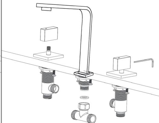
5. Instale os flexíveis menores (8) no "T" hidráulico (9) e os conecte com as saídas laterais das bases (7) de água fria e água quente.
