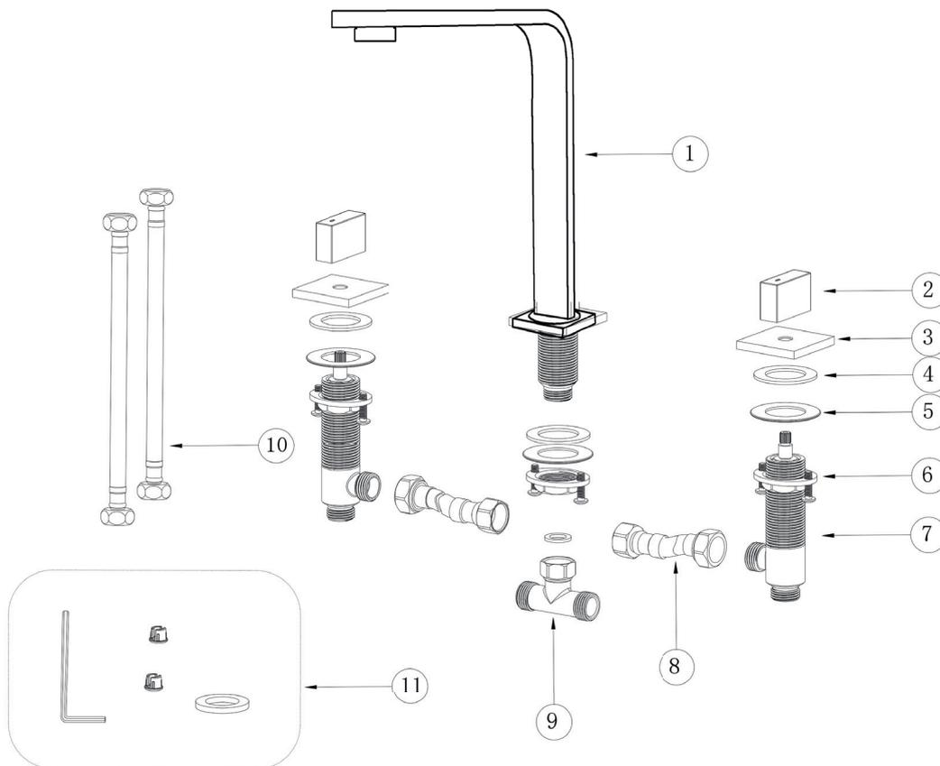
3. Fixe as duas bases (7) e a bica (1) na bancada com o auxílio de uma chave philps para apertar os parafusos de fixação (6).
